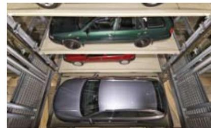
Raggiunta la posizione desiderata, il pallet si aggancia ad un altro. Prima di spingere i pallet nella griglia di deposito l'elevatore verticale viene fissato alla struttura in acciaio.
