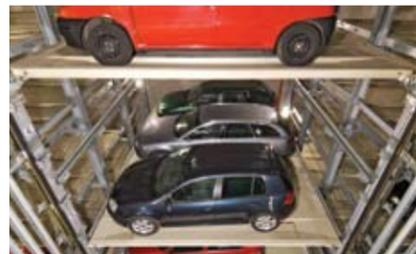
Il processo di deposito è ora completato e l'elevatore verticale porterà un pallet vuoto all'area di trasferimento. In questo lato dell'elevatore verticale i posti auto sono posizionati in tre file, sull'altro lato invece vi è una singola fila.
