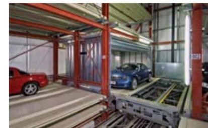
Una porta laterale all'interno dell'area di trasferimento apre l'accesso alla griglia di deposito e allo stesso tempo l'unità di deposito e prelievo sull'elevatore verticale si posiziona adiacente ad essa. Il pallet con l'auto viene collocato sull'unità di deposito e prelievo e una volta posizionato correttamente si blocca.
