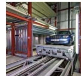
L'elevatore si solleva e l'unità di deposito e prelievo si muove in orizzontale. Un nuovo pallet sotto l'area di trasferimento viene sollevato pronto per il prossimo accesso.
