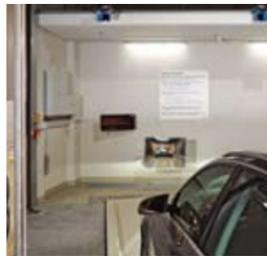
L'utente entra nell'area di trasferimento e posiziona l'auto sul pallet disponibile. Per eseguire la manovra l'utente viene aiutato da uno specchio e da un display installati di fronte.
